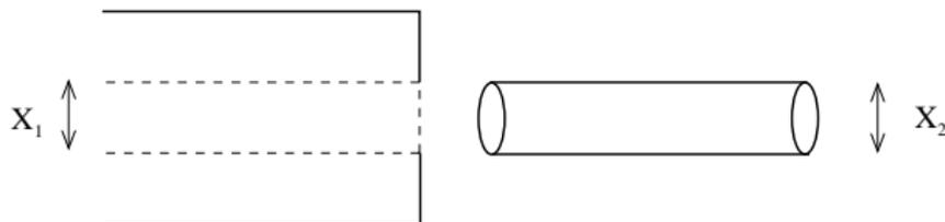
Si  $X_1 \sim N(1.5, 0.0016)$  et  $X_2 \sim N(1.48, 0.0009)$  sont les deux diamètres, le jeu entre les deux éléments est  $Y = X_1 - X_2$ . Les v.a.  $X_1$  et  $X_2$  sont indépendantes.
